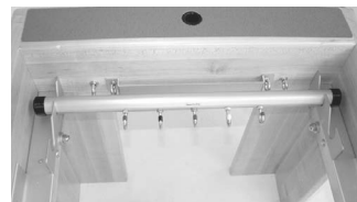
Barra de muelles instalada
