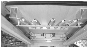
Muelles apoyados sobre el brazo debajo del carro
