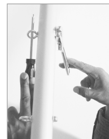
Figura 8: Use dos dedos para apretar las tuercas
